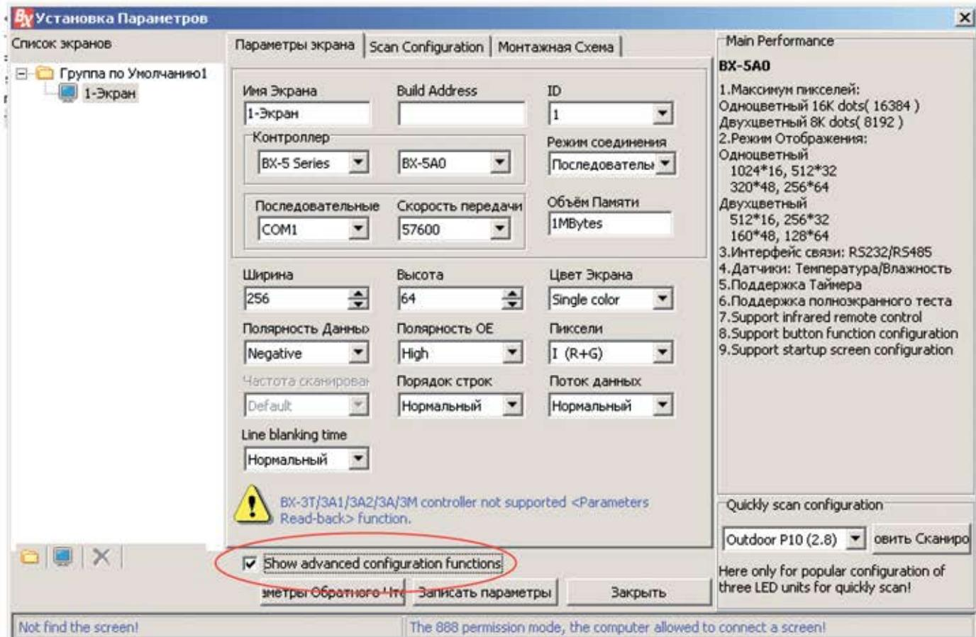
После этого в верхнем меню появится дополнительная кнопка "Advanced Configuration". В нем выбираем "Sensors Configuration".
