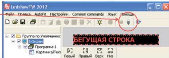
Чтобы синхронизировать время/дату компьютера с табло, нужно поставить галочку на "Correction time", и указать разницу во времени (засекаем время от нажатия на Save до вставки флешки в табло)
