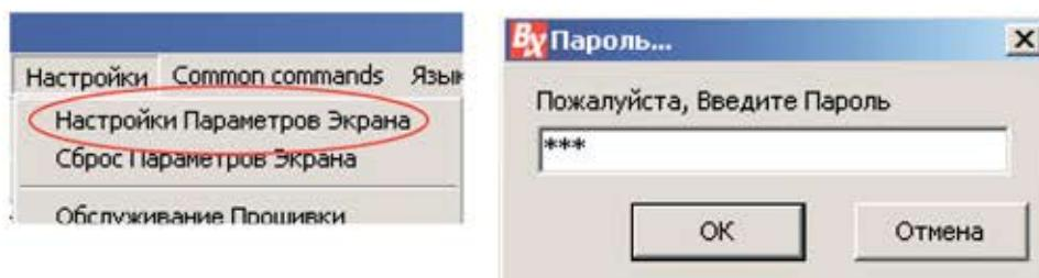
Для входа в настройки конфигурации нажимаем соответствующую кнопку в меню. При выходе окошка с запросом пароля вводим "888" и нажимаем "OK".
